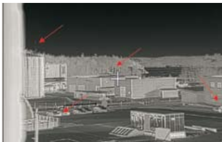
図7:DDE適用結果 - すべてのターゲットの同時表示
